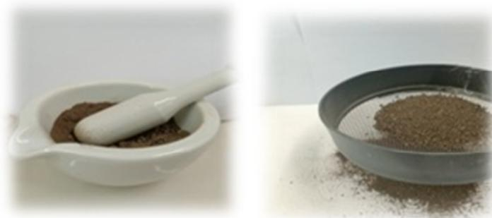
**Figure 09 :** Broyage et tamisage des échantillons de sol
